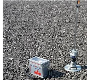
Der SGS Einbau war bereits 13.00 Uhr mit dem Verdichtungsnachweis durch die dyn. Fallpatte beendet.
